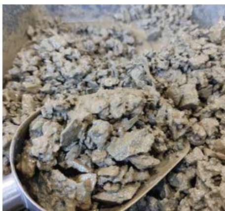
Material na umidade ótima para compactação
