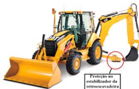
Figura 10 – Proteção do estabilizador da retroescavadeira
