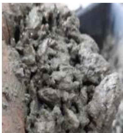
Material com umidade excessiva
