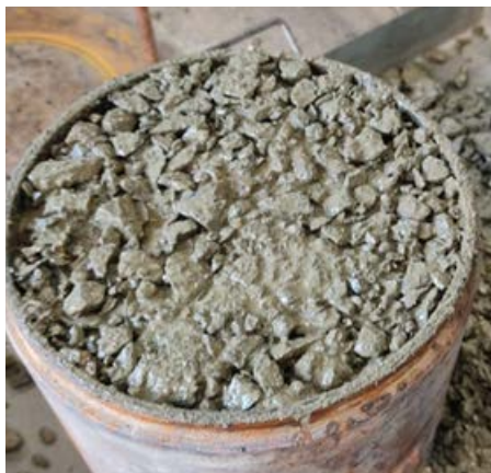
Material compactado na umidade ótima
