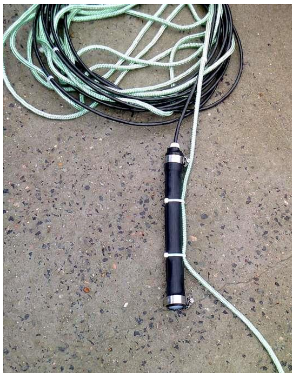
Figura 13 – Exemplo de forma de montagem da sonda de nível com câmara de bicicleta.
